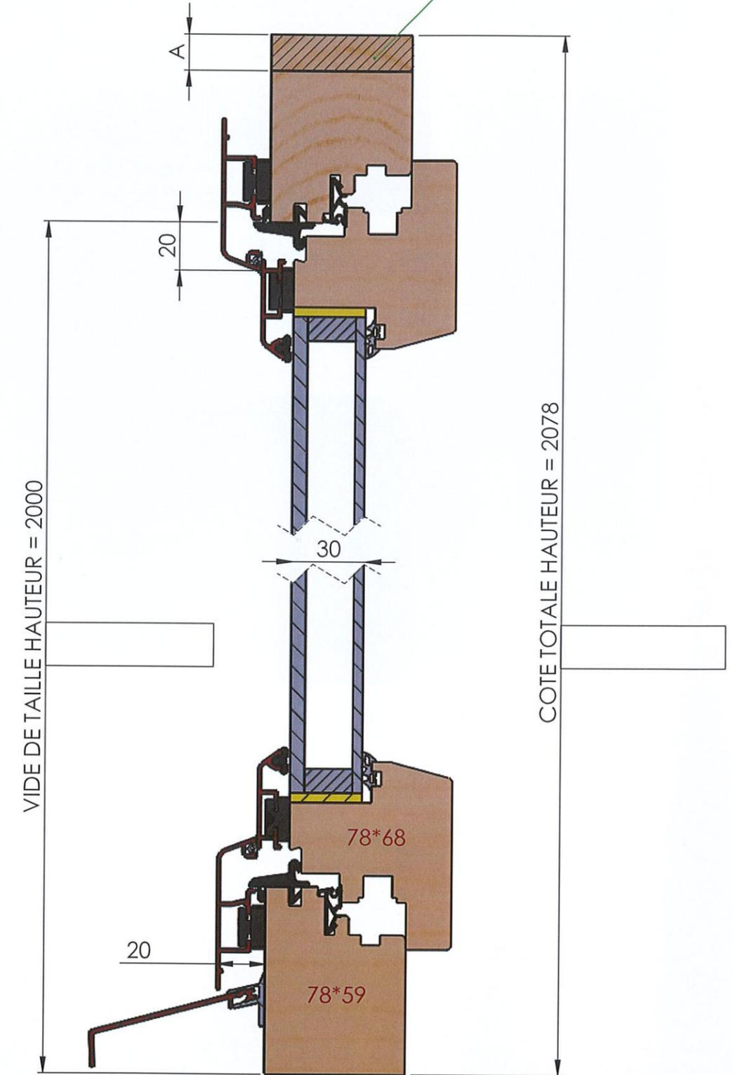
COUPE LARGEUR / HAUTEUR USINAGE FENETRE BOIS-ALUMINIUM
